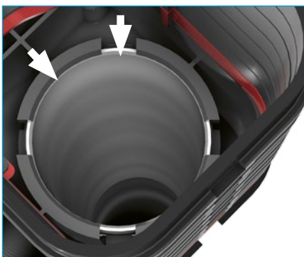
Sichtkontrolle: Oberkante Hülsrohr rastet deutlich sichtbar in Halterung ein (Pfeile)
